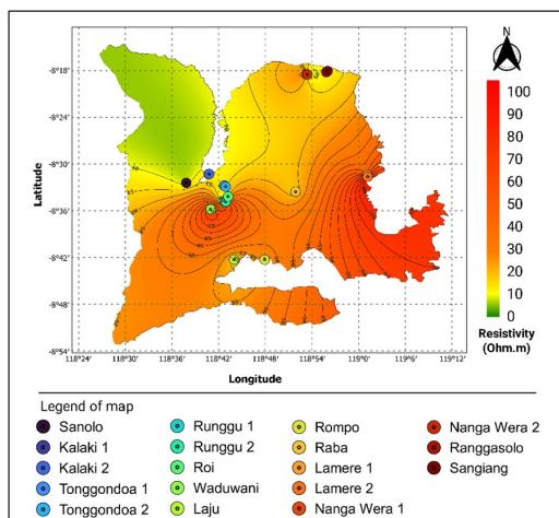
Gambar 5. Kontur resistivitas pada kedalaman 40 meter. Sebagian VES adalah akuifer terbuka.
