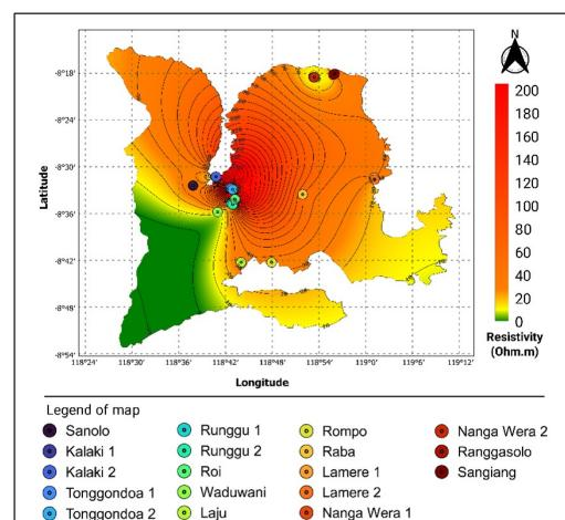
Gambar 9. Kontur resistivitas pada kedalaman 100 meter. Indikasi adanya akuifer tertekan berada di titik Desa Waduwani, Lamere 2, dan Ranggasolo.
