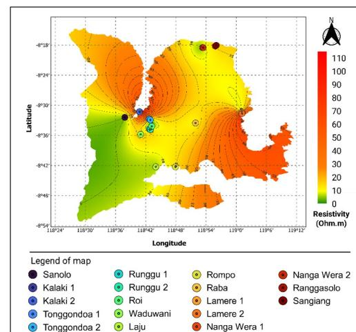
Gambar 3. Kontur resistivitas pada kedalaman 10 meter. Akifer bebas berada di Desa Tonggondoa 1, Runggu 2, Waduwani, Rompo, Raba, Ranggasolo dan Sangiang.
